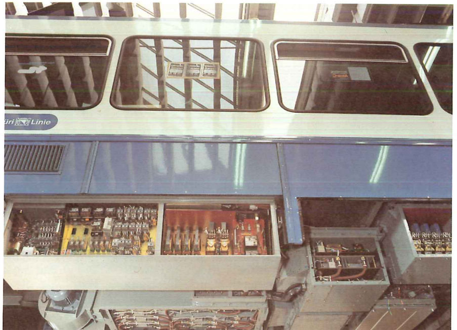
Bild 4 – BBC-Umrichter mit Gleichstrom-Zwischenkreis mit eingprägtem Strom für Drehstromantrieb bei Strassenbahntriebwagen 2008 der VBZ
