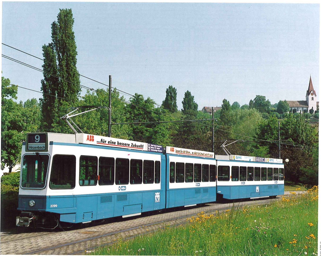
Bild 1 – Strassenbahn-Zug «Tram 2000-III» mit Gelenktriebwagen Be 4/6 und motorisiertem Beiwagen Be 2/4 mit Drehstromantrieb im Betriebseinsatz auf dem Netz der VBZ
